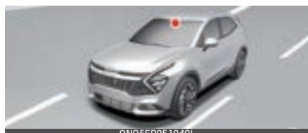
Skata uz priekšu kamera kalpo kā atklāšanas sensors, lai atpazītu apkārtējo gaismu un spilgtumu braukšanas laikā. Skatiet atklāšanas sensora atrašanās vietu attēlā augstāk.
