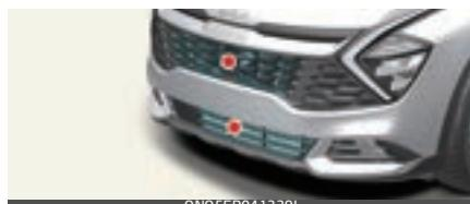
Aktīvais gaisa aizvars kontrolē gaisa aizvaru, kas atrodas zem priekšējā bufera, lai dzesētu automobiļa daļas un uzlabotu energoefektivitāti.
