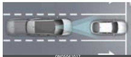
Izvairīšanās no frontālas sadursmes palīgsistēma ir paredzēta, lai palīdzētu konstatēt un uzraudzīt priekšā braucošo automobili vai palīdzētu konstatēt gājēju vai velosipēdistu uz braucamās daļas, brīdinot vadītāju ar brīdinājuma paziņojumu un akustisko brīdinājumu, ka ir iespējama sadursme, un ieslēdz ārkārtas bremzēšanu.
