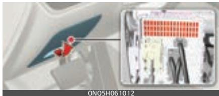
3. Izvelciet aizdomīgo drošinātāju ārā. Izmantojiet drošinātāju izņemšanas instrumentu (1), kas atrodas drošinātāju blokā motora nodalījumā.
