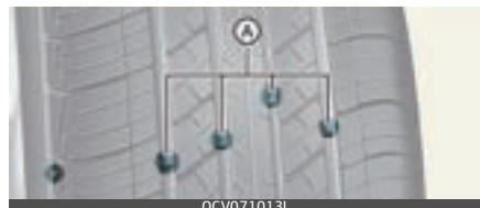
A: Protektora nodiluma indikators
