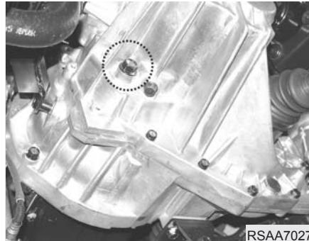
2. Izvelciet aizbāzni, kas atrodas ātrumkārbas apakšā.
